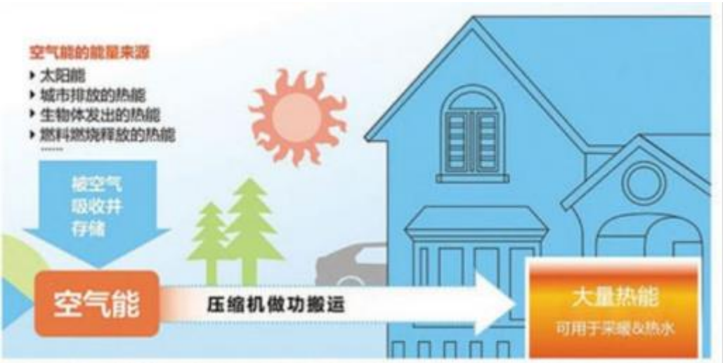
图 2.3-2 空气能能量来源示意图
